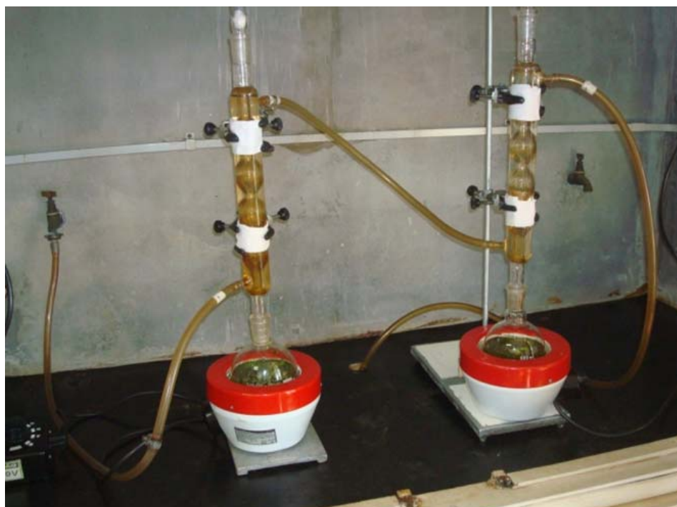
Figura 2. Preparação de extrato etanólico na capela, sob refluxo lento. UFLA, Lavras, MG, 2011.
