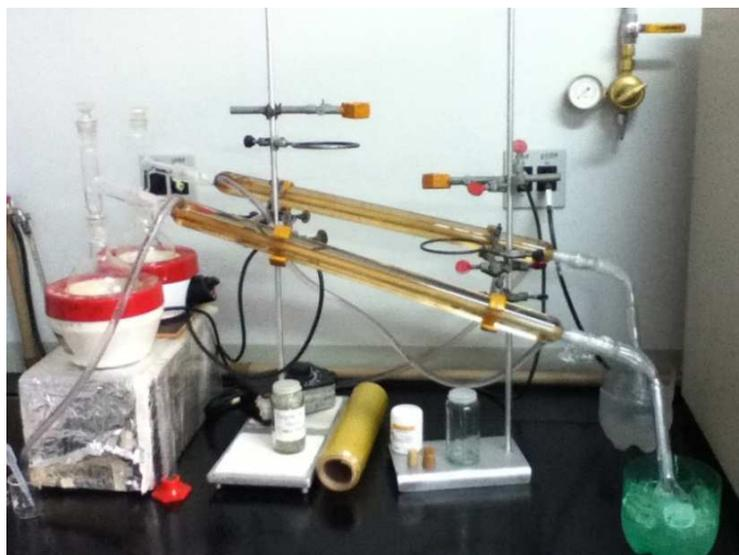
Figura 6 Destilador empregado para redestilar as amostras
