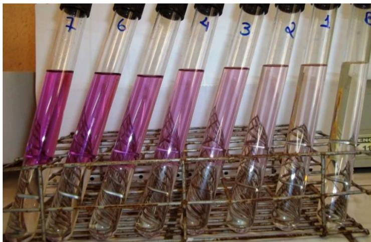
Figura 12 Soluções-padrão empregadas para construção da curva analítica para análise de cobre, por meio da qual possível observar o composto de coloração violeta formado
