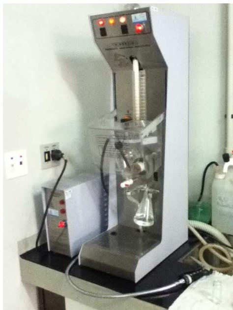
Figura 7 Destilador Eletrônico Enochimico Gibertini
