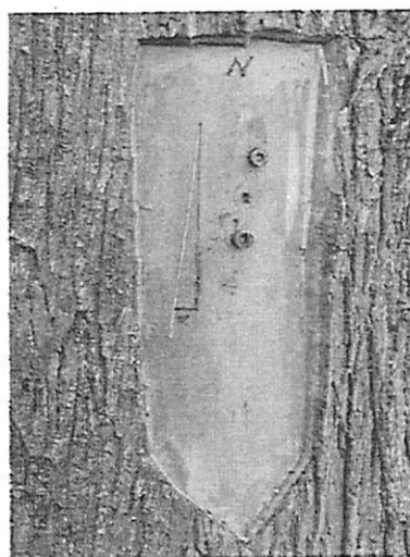
FIGURA 2.2. Pinos fixados no sentido do desvio da grã a uma distância de 45 mm com a marcação da posição para furo com arco-de-pua
