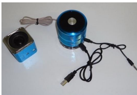
Figura 2 Caixa de som adaptada com dois alto-falantes.
