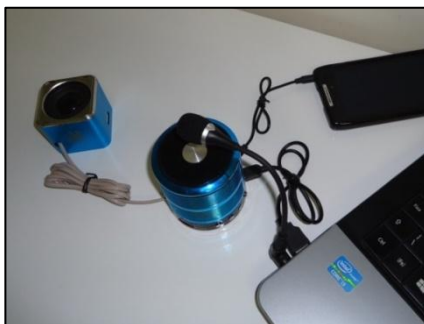
Figura 4 Ligações entre caixa de som adaptada, o celular e o PC.
