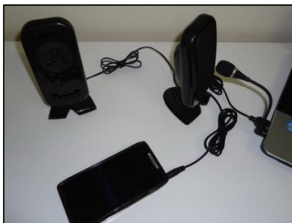
Figura 3 Ligações em caixa de som com dois alto-falantes, o celular e o PC.
