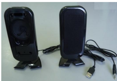
Figura 1 Caixa de som constituída por dois alto-falantes.
