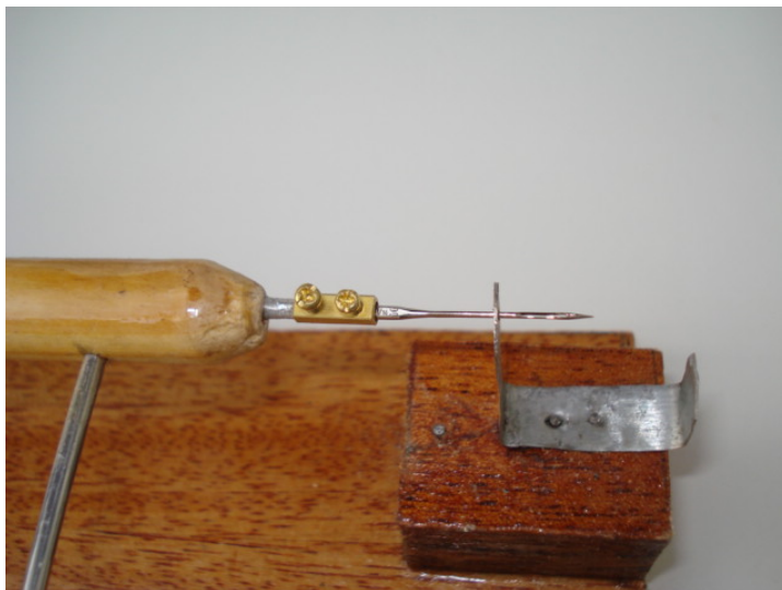
Figura 10 – Detalhes da agulha, na ponta do eixo, para diminuir o atrito
