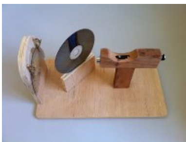
Figura 14 – Aparato experimental para observação do fenômeno da difração.
