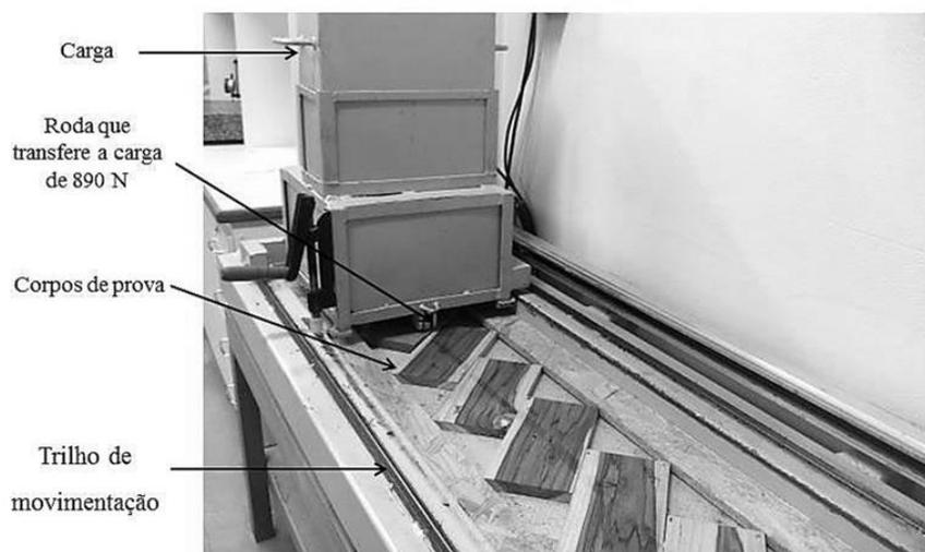
Figura 4 Equipamento para o ensaio de carga rolante
