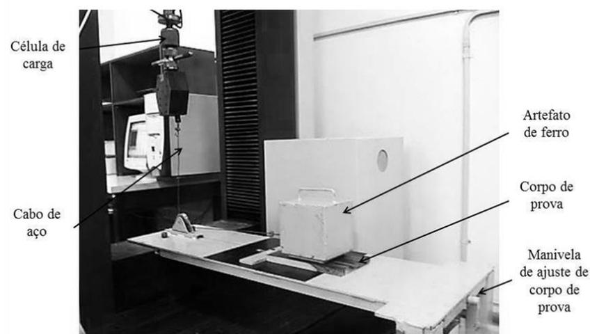
Figura 8 *Setup* do ensaio de determinação do coeficiente de atrito.
