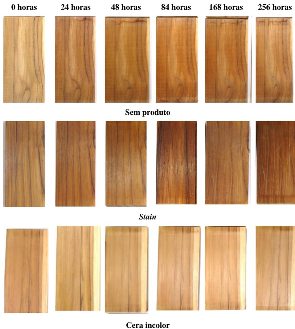
Figura 22 Superfície da madeira teca para os três tratamentos antes e depois do envelhecimento acelerado
