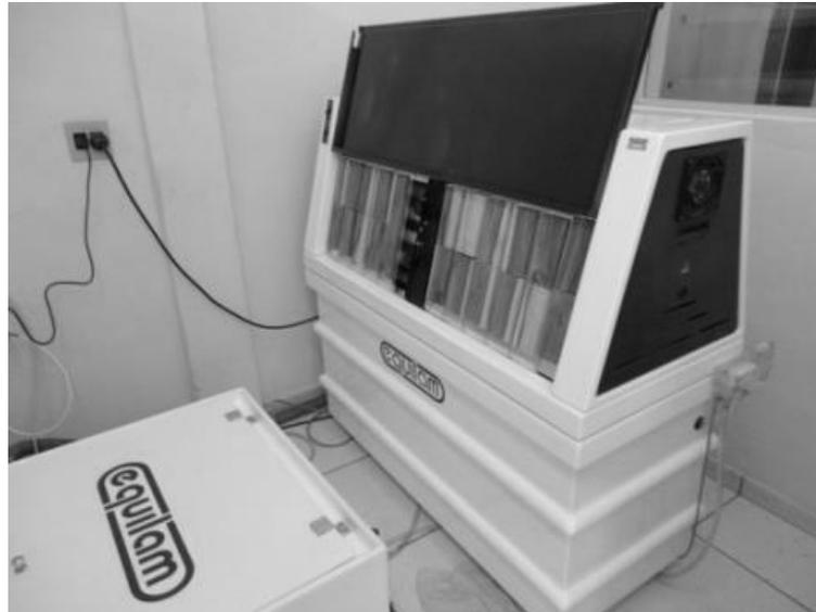
Figura 9 Equipamento para ensaios de envelhecimento acelerado
