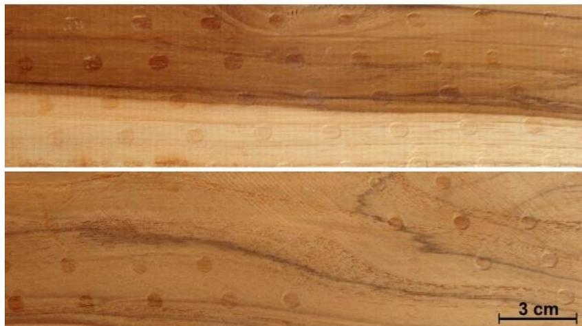
Figura 15 Dano gerado na madeira após o ensaio de endentação em pequenas áreas.
