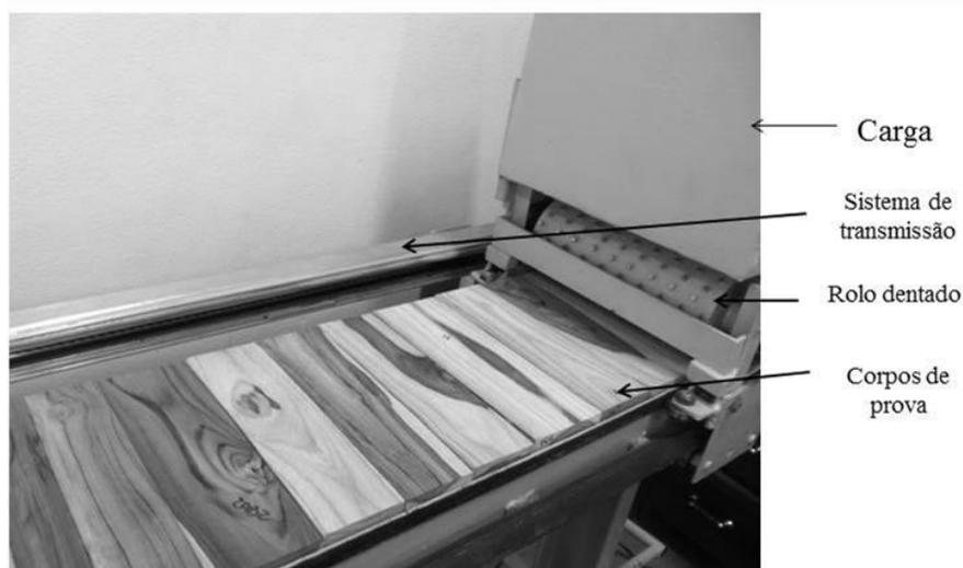
Figura 5 Equipamento para ensaio de endentação em pequenas áreas
