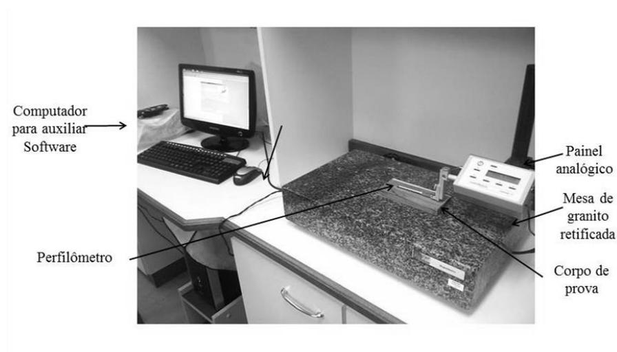
Figura 12 *Setup* das mensurações da rugosidade da superfície após ciclos de envelhecimento.
