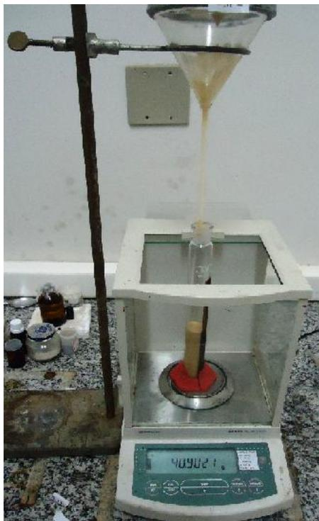
Figura 7 Equipamentos utilizados na avaliação da resistência ao derretimento
