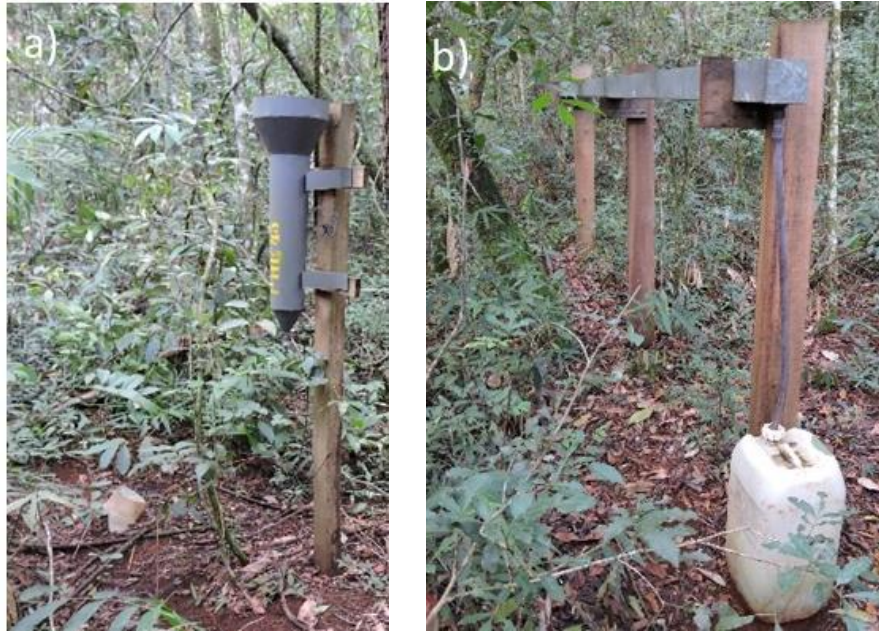
Figura 5 Pluviômetros (a) e calhas (b) instalados na FESM
