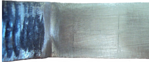
Figura 20 Marcação para colagem dos extensômetros
