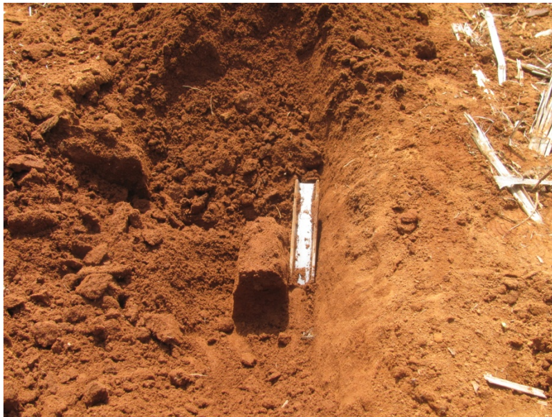
Figura 38 Preparo da amostra indeformada da parede lateral do sulco
