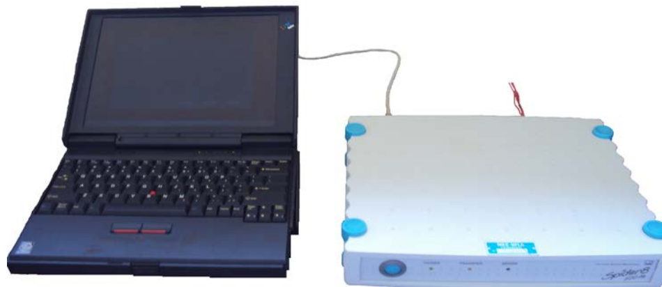
Figura 23 Sistema de condicionamento e armazenamento de sinais
