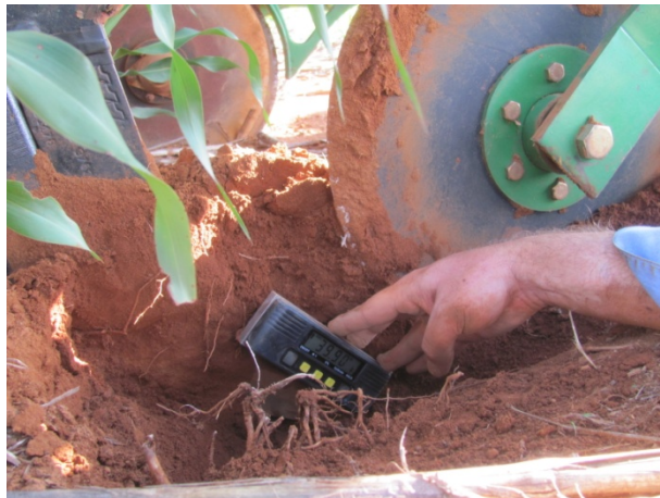
Figura 27 Inclinômetro digital utilizado para conferir o ângulo de ataque
