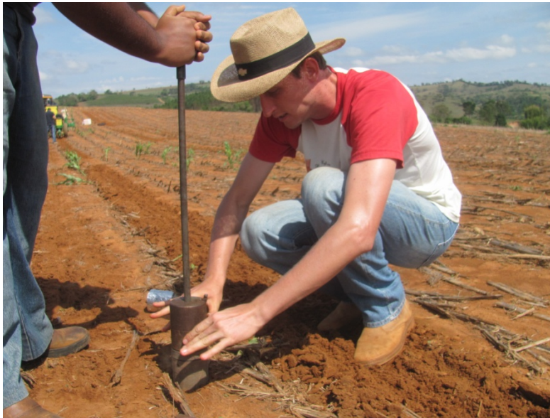
Figura 28 Coletas de amostras de solo indeformadas com trado Uhland
