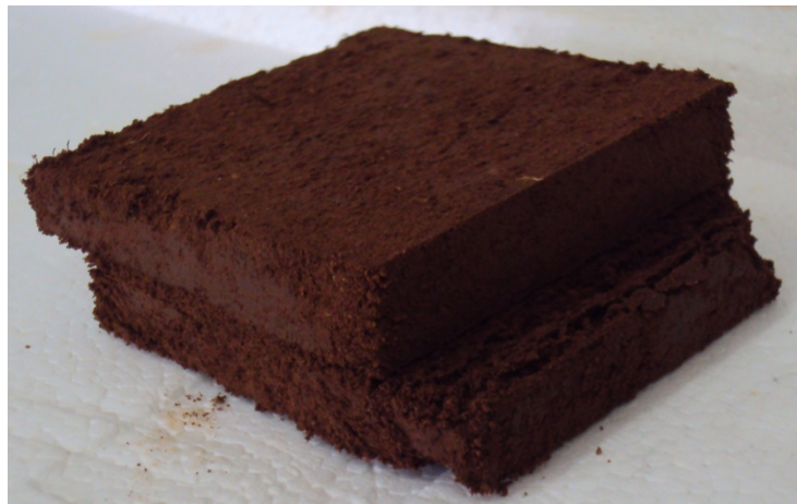
Figura 34 Amostra deformada pelo ensaio de cisalhamento direto
