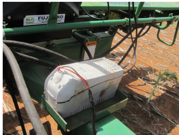
Figura 26 Nobreak utilizado para ajustar a tensão
