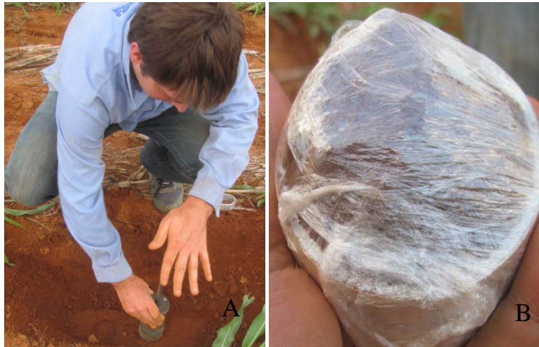
Figura 35 (A) Coleta da amostra indeformada; (B) amostra coletada e condicionada
