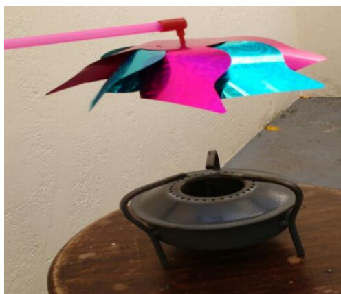
Figura 4 - Arranjo experimental utilizado para discussão do processo de propagação de calor por convecção de gases.
