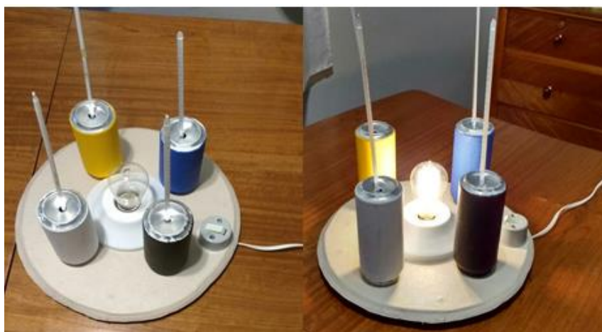
Figura 5 - Arranjo experimental utilizado para discussão do processo de propagação de calor por radiação
