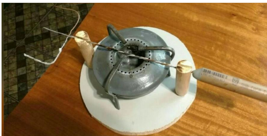
Figura 1 - Arranjo experimental utilizado para discussão do processo de propagação de calor por condução
