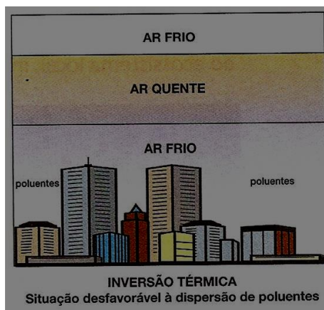
Figura 2: Representação esquemática do fenômeno de inversão térmica. Fonte: Kantor (2010), vol. 3. p.217.
