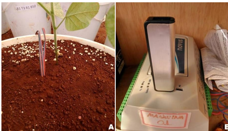
Figura14 - Distribuição dos sensores no solo e (A) equipamento de registro automático FieldLogger (B).
