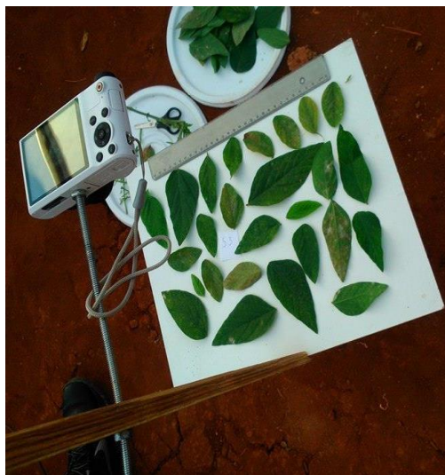
Figura 10 - Dispositivo de fixação da câmera fotográfica para obtenção das imagens das folhas para fins de processamento.
