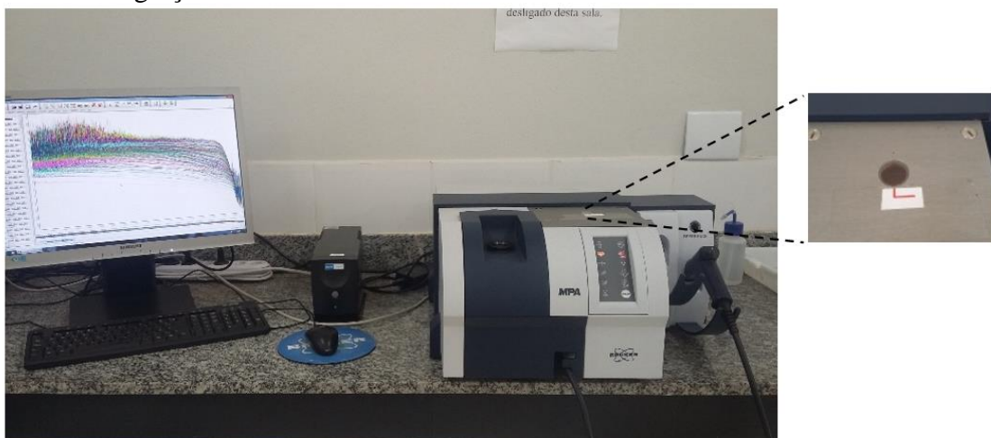
Figura 9 - Espectrômetro Bruker acoplado ao computador com destaque para a esfera de integração
