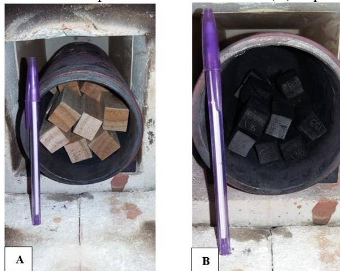
Figura 8 - Amostras dentro da cápsula do forno mufla antes (A) e após (B) a carbonização
