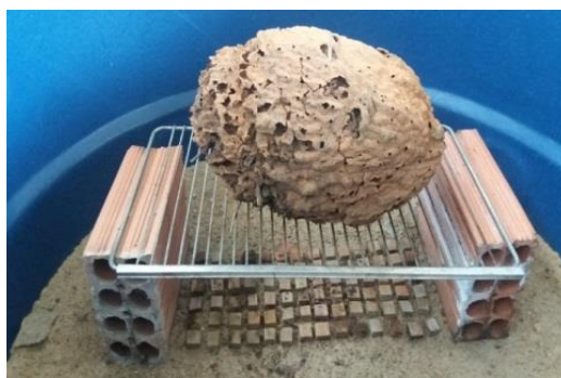
Figura 3 – Ensaio de preferência alimentar com térmitas, com colônia de térmitas sem contato físico com os corpos de prova.
