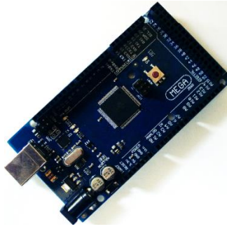
Figura 3 - Placa eletrônica Arduino modelo Mega.
