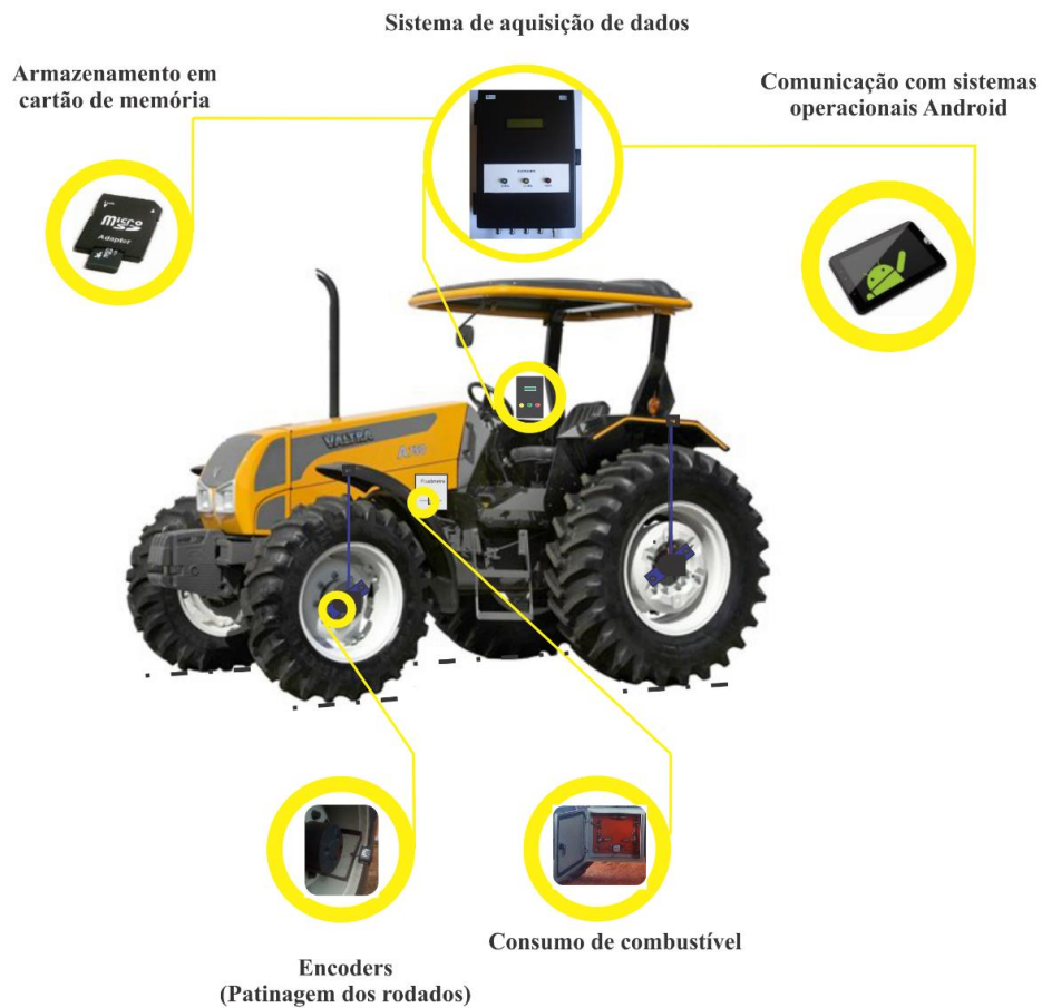
Figura 2 - Visão geral do sistema de aquisição de dados.
