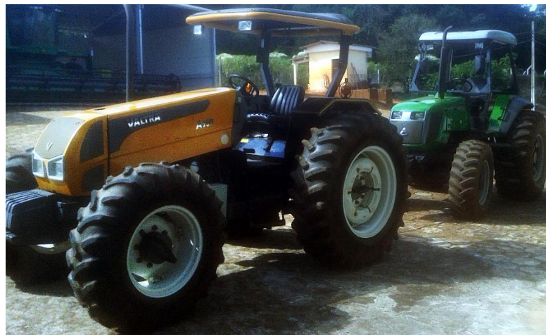
Figura 17 - Direita - Trator da marca Valtra utilizado para tração. Esquerda - trator “freio” da marca Agrale sendo arrastado.
