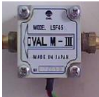
Figura 12 - Fluxômetro de combustível utilizado para medição do consumo de combustível.
