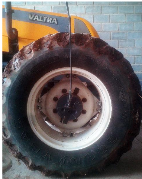
Figura 20 - Instalação dos encoders nos rodados do trator
