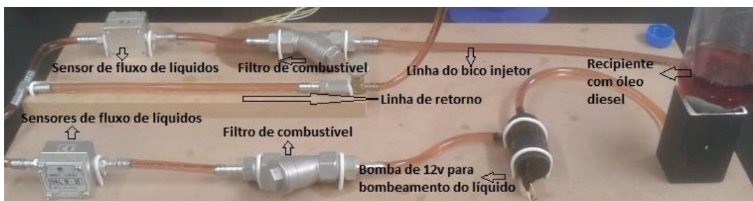
Figura 15 - Bancada de ensaio para testes com placa de controle Arduino e sensores de vazão de líquidos simulando funcionamento dos fluxômetros.
