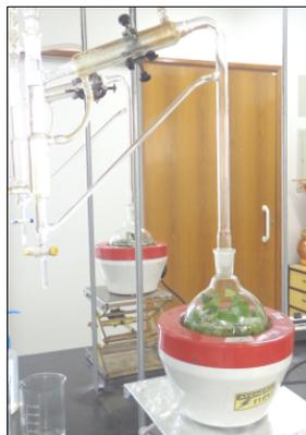
Figura 6 Processo de extração dos óleos essenciais (hidrodestilação).
