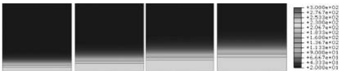
Figura 11 – Aumento da temperatura, em graus Celsius, e da camada carbonizada da madeira, para os tempos de exposição ao incêndio de 15, 30, 45 e 60 minutos, respectivamente, da esquerda para direita.
