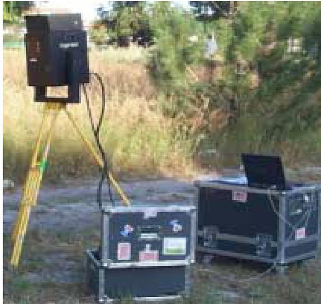
Figura 5 Arranjo experimental de um scanner laser
