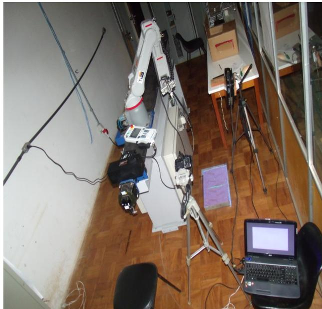
Figura 13 Arranjo experimental da digitalização da simulação das marcas das garras do pneu do trator no solo através da luz laser
