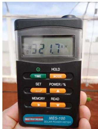
Figura 9 Medidor de Energia Solar portátil
