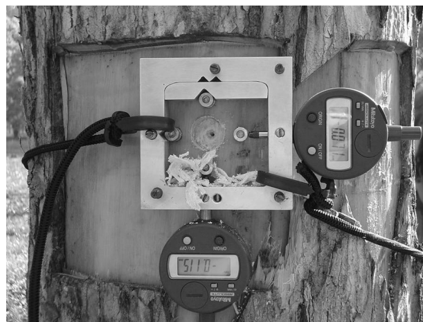
Figura 1 – Detalhes do extensômetro usado na medição da deformação residual longitudinal (DRL) e tangencial (DRT).
