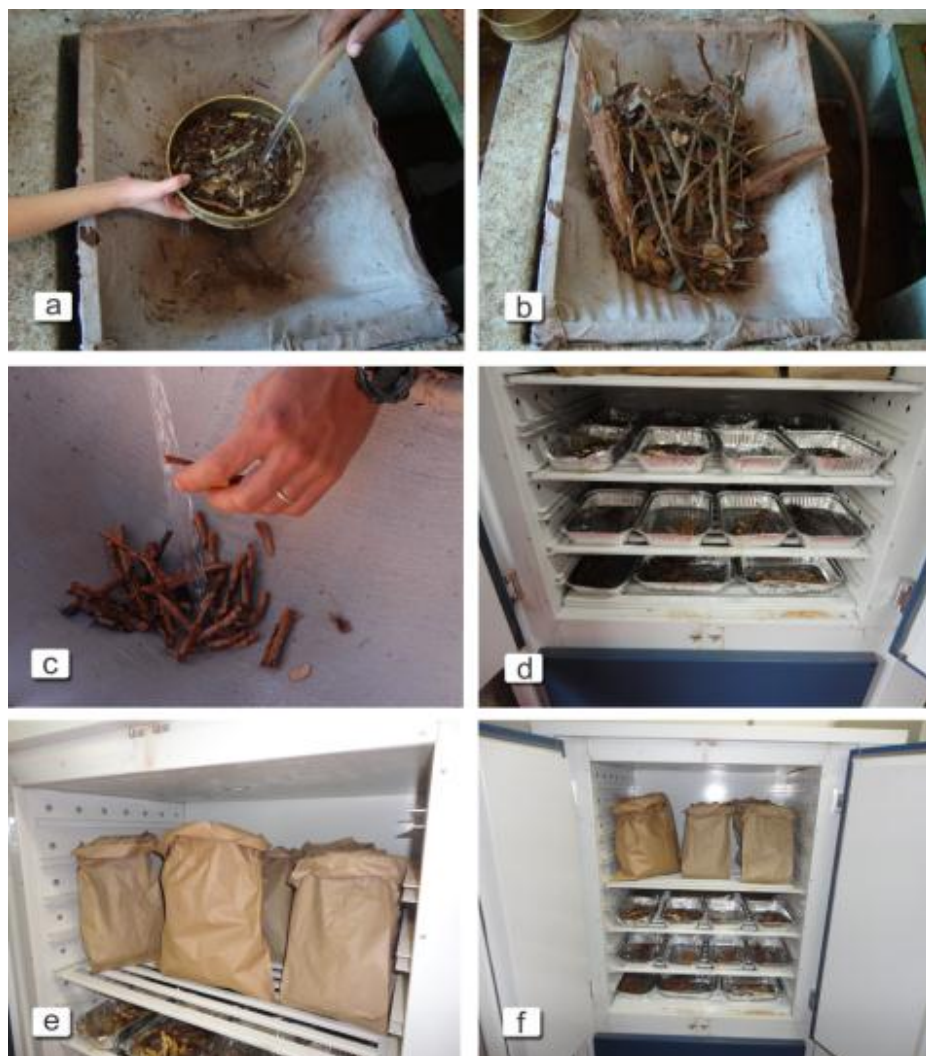
Figura 11 Lavagem das raízes e serrapilheira (a, b, c) e material secando na estufa (d, e, f)
