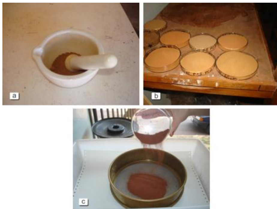
Figura 15 Gral de porcelana e pistilo (a), amostras de solo secando ao ar (b) e sendo peneiradas (c)
