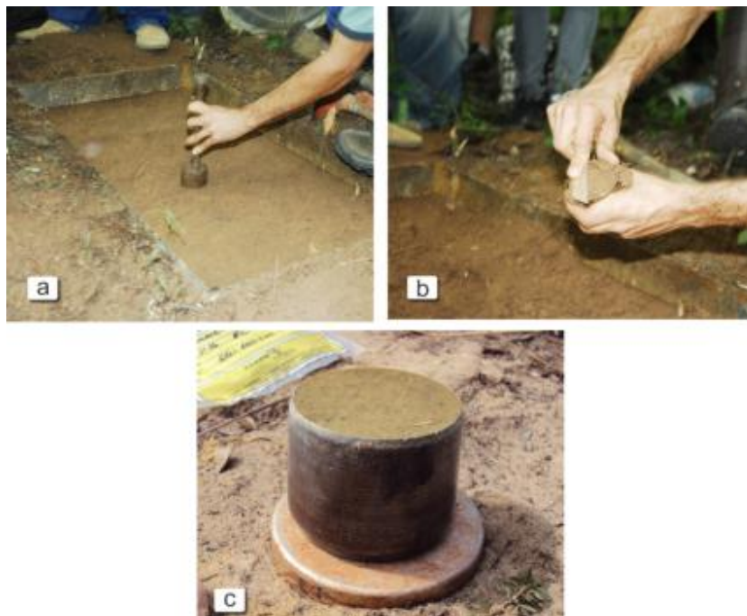
Figura 10 Coleta de solos para análise da densidade do solo (a, b) e anel utilizado para coleta (c)
