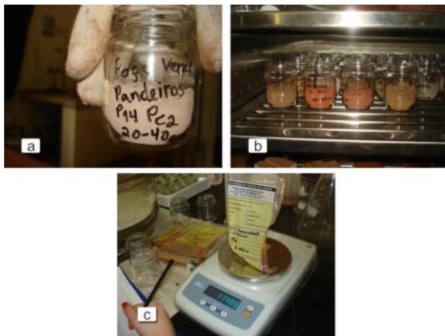
Figura 16 Amostra de solo para determinação da densidade (a), secando em estufa (b) e sendo pesadas (c)
