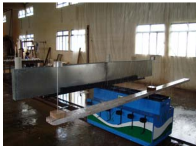
FIGURA 7 Área experimental constituída de: A) Emissor Quad-Spray com regulador de pressão e estrutura de coleta de dados; B) Dispositivo de Movimento Linear Controlado (DMLC) e painel de controle de velocidade; C) Suporte para coletores de água e amostras de solo fixado sobre o DMLC. Laboratório de Irrigação, DEG/UFLA.
