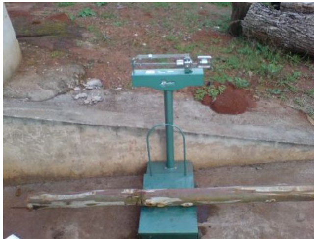
Figura 1 – Pesagem de tora de Eucalyptus grandis em balança mecânica.
