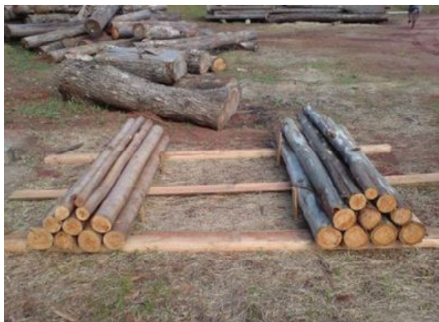
Figura 2 – Pilhas de secagem de toras sem casca e com casca de Eucalyptus grandis , em Lavras, MG.
