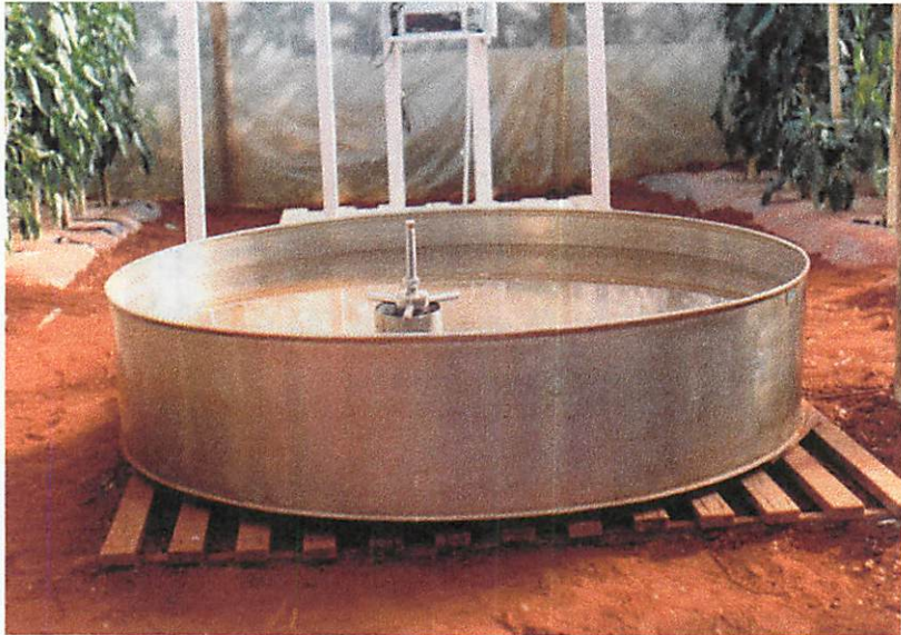
FIGURA 3 - Vista geral do tanque Classe A
