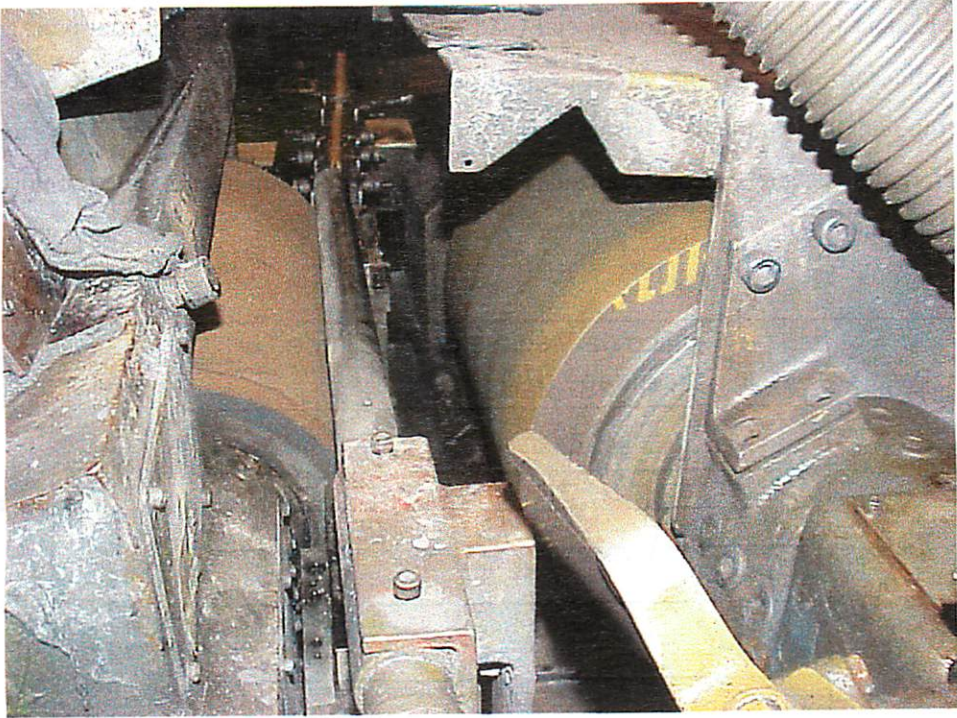
FIGURA 12 - Vista da retífica “CENTRELESS” pelo lado de saída da haste
