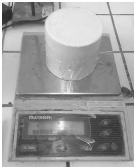
Figura 5- Determinação da massa unitária do gesso
