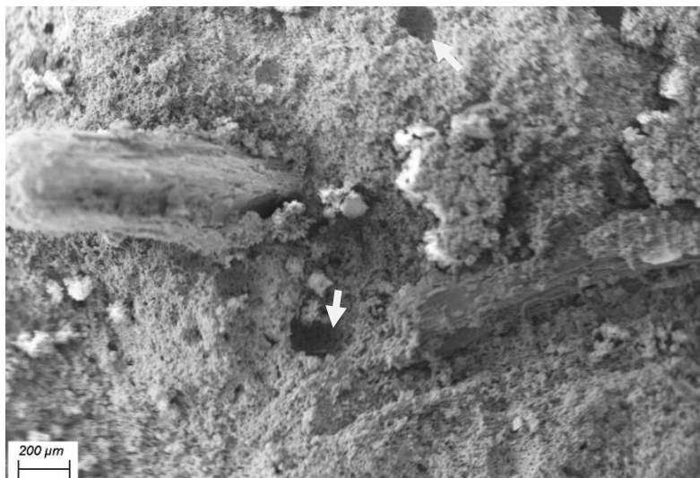
Figura 21- Micrografia do compósito de gesso com partículas de eucalipto
