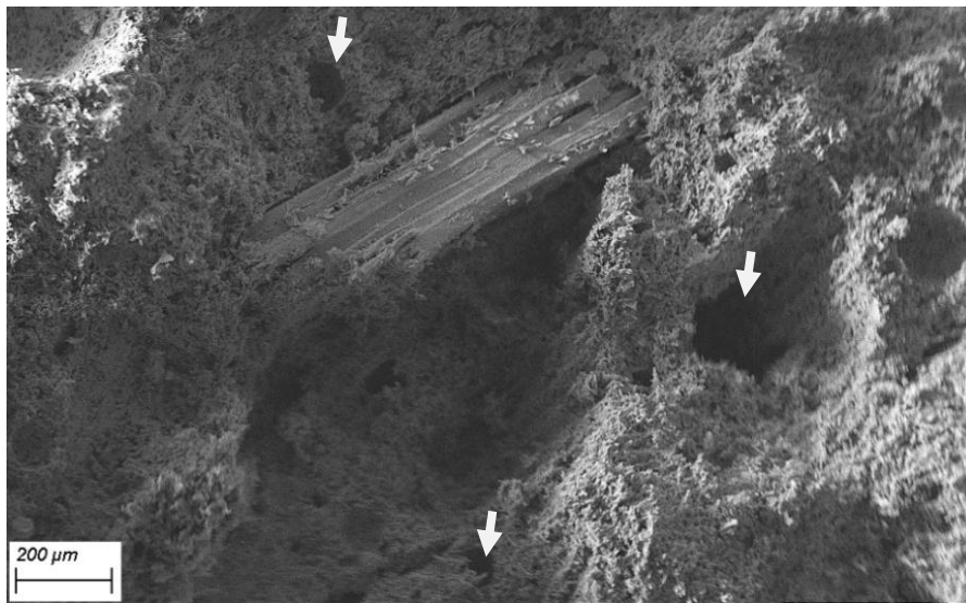
Figura 20- Micrografia do compósito de gesso com partículas de pinus
