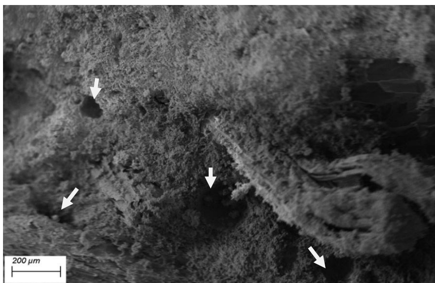
Figura 19- Micrografia do compósito de gesso com partículas de bagaço de cana de açúcar
