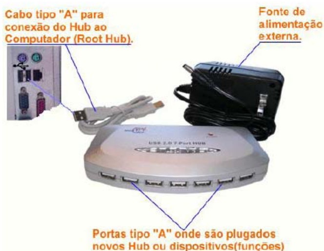
Figura17 Mostra um Hub de 7 portas, sua fonte de alimentação e um cabo para conectar ao Host/controlador
