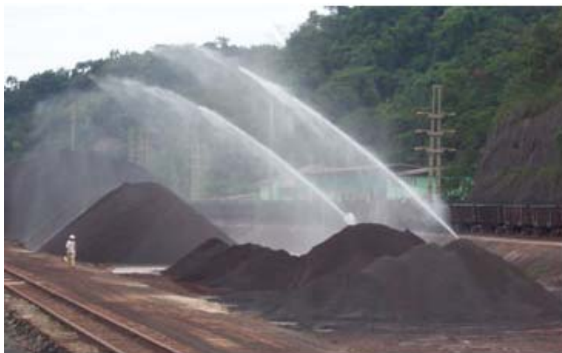
Figura 1 Sistema de aspersão Fonte: Irricom (2011)
