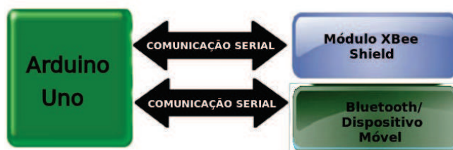
Figura 11 Comunicação entre Arduino, Módulo Xbee e Dispositivo Móvel
