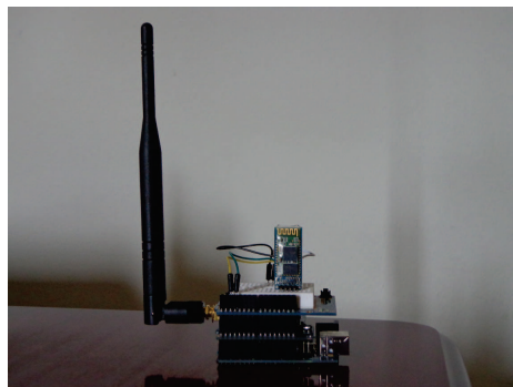
Figura 10 Nó para comunicação veicular
