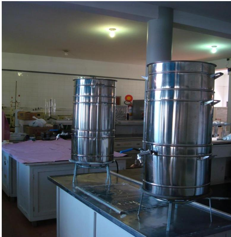
Figura 1 Equipamento artesanal de extração de suco por arraste de vapor (“suqueira”)
