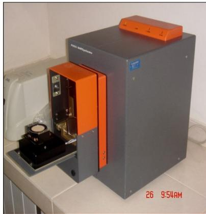
FIGURA 5 Espectrômetro NIRS, da marca FOSS, modelo NirSystem 5000
