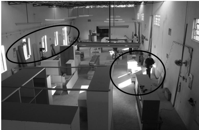
Figura 9 Estrutura de uma fábrica de móveis com ofuscamento (em destaque), causado por aberturas feitas para entrada de luz solar.
