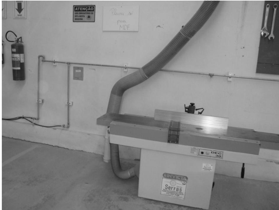
Figura 8 Plana desempenadeira de uma fábrica de Cruzília/MG, com sistema de exaustão.
