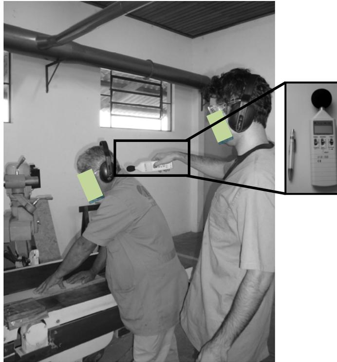
Figura3 Metodologia de medição do nível de pressão sonora, por meio de decibelímetro.
