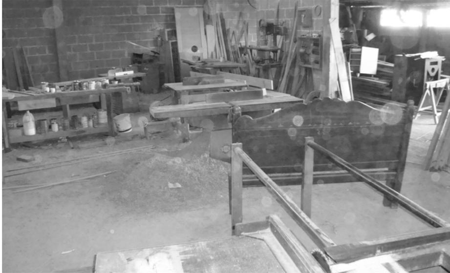
Figura 7 Acúmulo de serragem próximo ao posto de trabalho em fábrica de móveis em Cruzília/MG.
