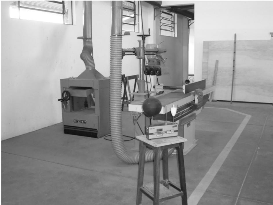
Figura5 Medição de temperaturas, para cálculo de IBUTG nas fábricas de móveis.
