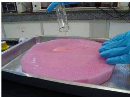
Figura 3 Embebição da esponja com solução de ácido fosfórico e glicerina
