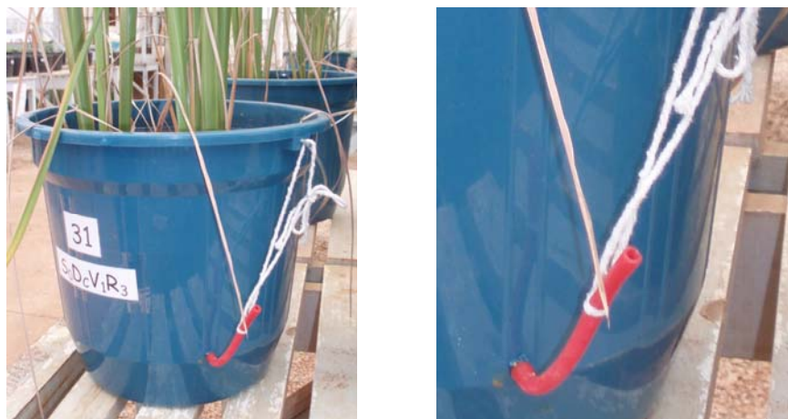
FIGURA 3. Visualização do controle do fluxo de lixiviado.
