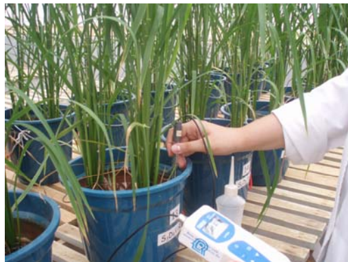
FIGURA 5. Determinação do potencial redox (Eh).
