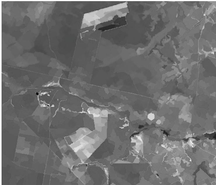
Figure 19 Imagem segmentada com atribuição de um nível de cinza para cada segmento, correspondendo à média dos valores dos pixels
