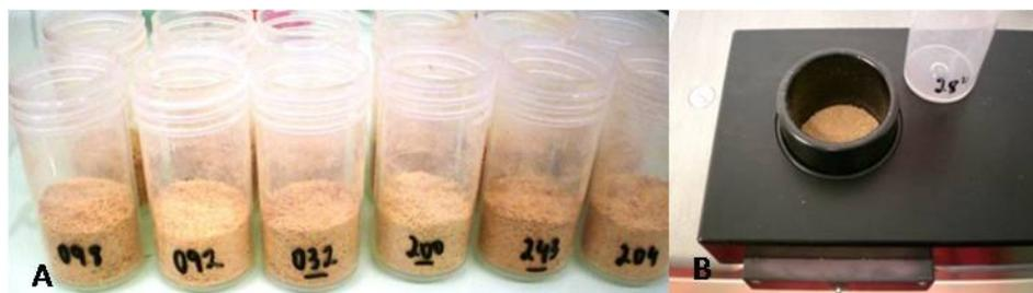
FIGURA 14 Amostras moídas (A) e *spinning cup* (B)
