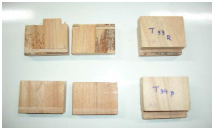
FIGURA 7 – Corpos-de-prova após cisalhamento.
