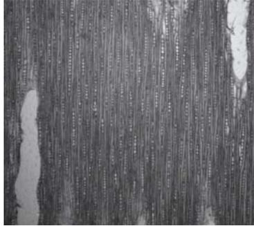
FIGURA 16 – Corte Longitudinal Tangencial do Clone 39 (aumento de 100x).
