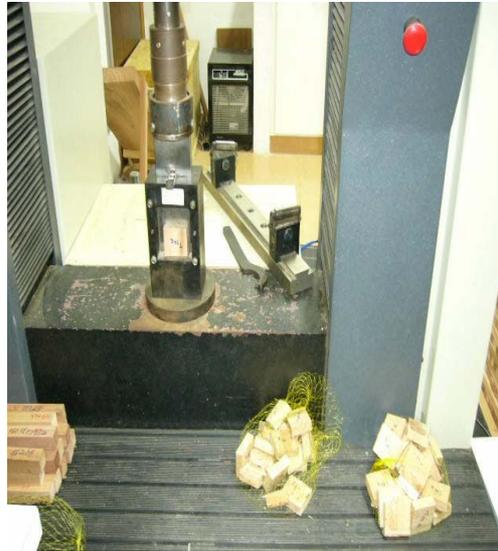
FIGURA 6 –Ensaio de cisalhamento na linha de cola.
