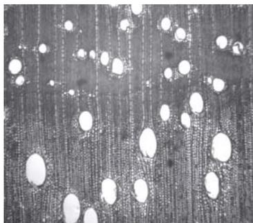
FIGURA 15 – Corte Transversal do Clone 26 (aumento de 40x).
