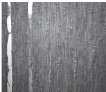
FIGURA 14 – Corte Longitudinal Radial do Clone 26 (aumento de 100x).
