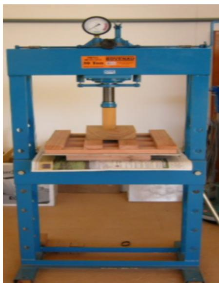
FIGURA 4 - Juntas sendo prensadas.
