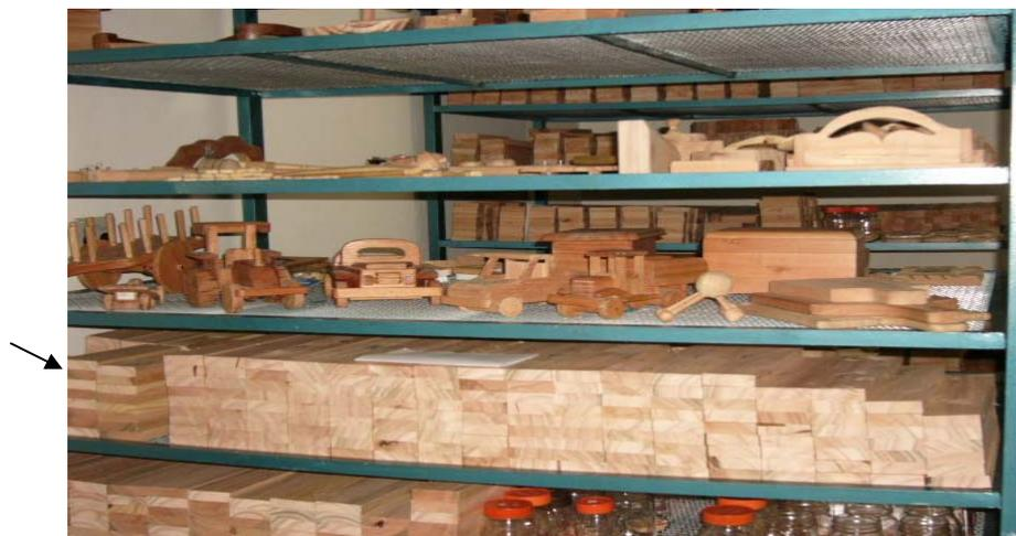
FIGURA 2 – Sarrafos para preparo das juntas coladas, acondicionados em sala de climatização.
