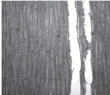
FIGURA 13 – Corte Longitudinal Tangencial do Clone 26 (aumento de 100x).
