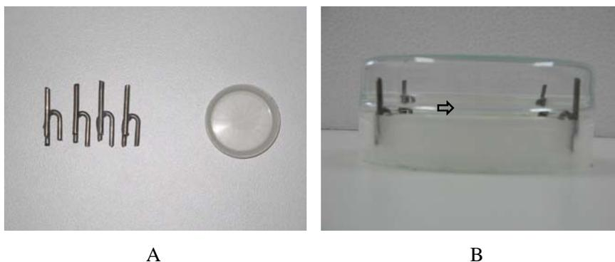
FIGURA 2. Grampos metálicos no formato de h, utilizados na montagem e fixação das placas de Petri, e tampa plástica onde se colocou à pasta Cândi (A). Esquema de montagem da arena, correspondendo a uma repetição, com destaque para a fresta entre as placas (B).
