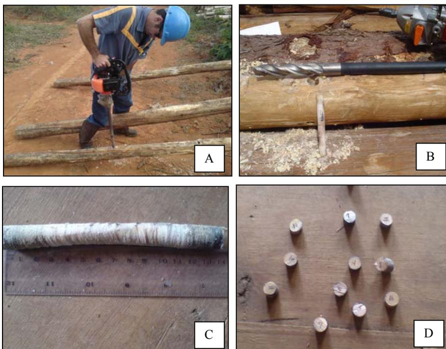
FIGURA 19 Retirada de bagueta com trado motorizado (A); bagueta (B e C); seções da bagueta (D).
