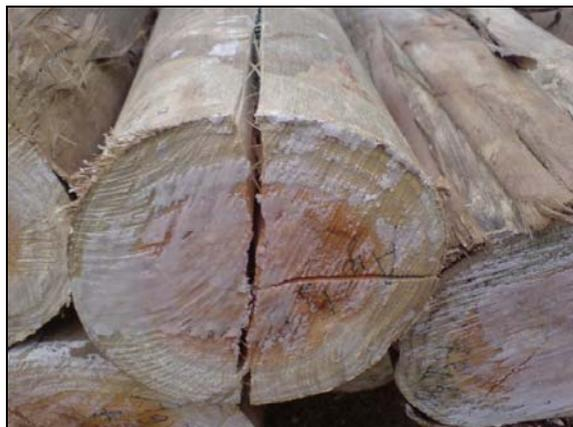
FIGURA 11 Rachadura de topo nas toras.
