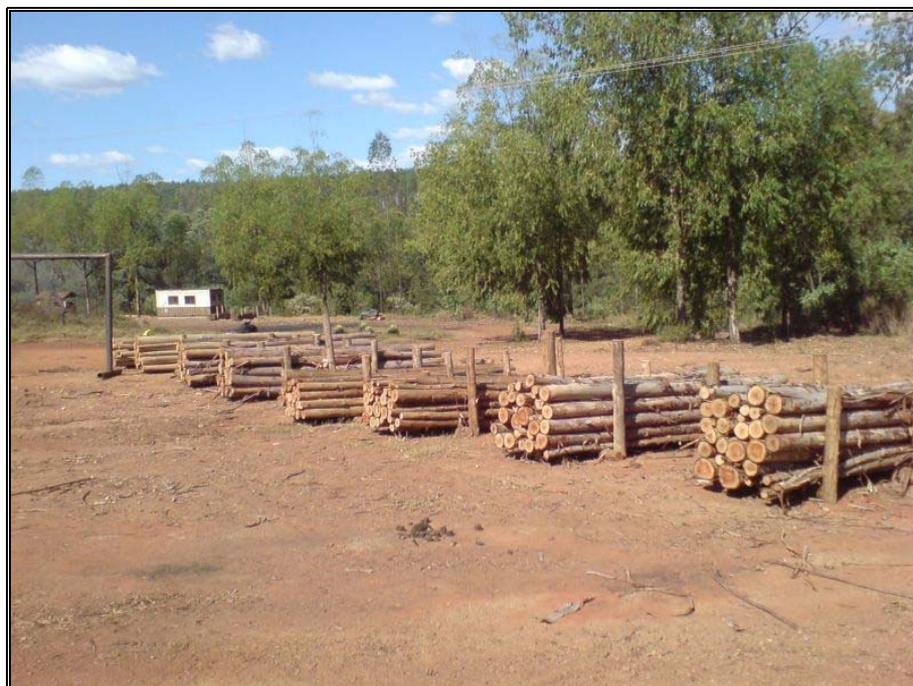
FIGURA 18 Pilhas de secagem ao ar livre de toras com casca e sem casca dos clones de *Eucalyptus* VM01 e MN463, em Paraopeba, MG.
