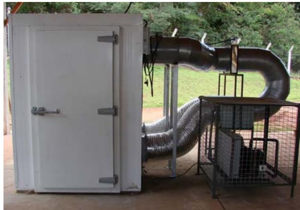
FIGURA 14 Câmara de desumidificação utilizada.
