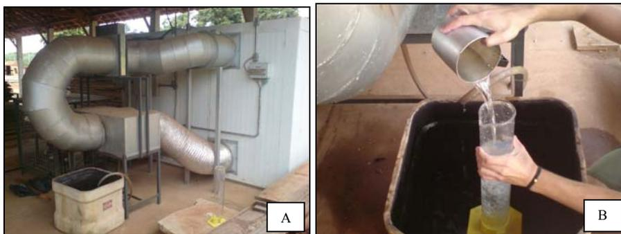
FIGURA 16 Caixa d'água conectada à câmara (A) e medição do volume de água removido e condensado durante a secagem(B).
