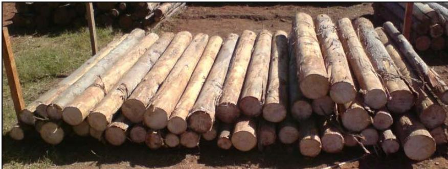
FIGURA 13 Pilha de secagem ao ar livre de toras de MN463 com casca e sem casca instalada em Lavras, MG.
