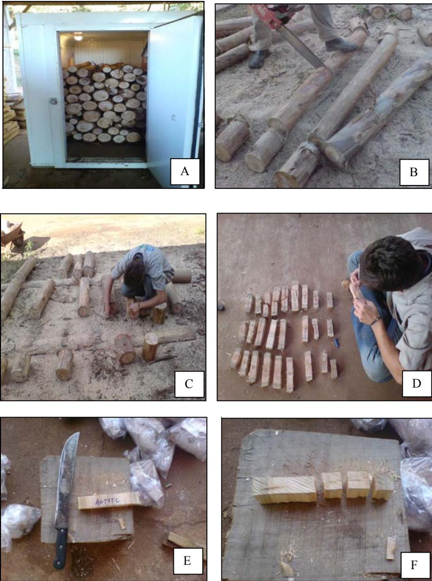
FIGURA 21 Toras na câmara de desumidificação (A); seccionamento das toras (B) e identificação dos discos (C); identificação das seções radiais (D); seção radial (E); seção radial dividida em amostras (F).
