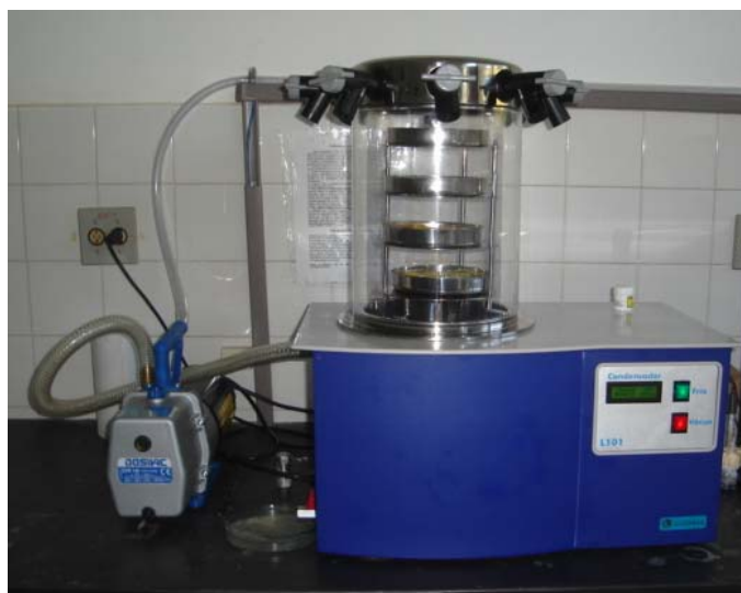
FIGURA 17 Liofilizador piloto Liobras L101 que consiste de uma câmara de vácuo, condensador, unidade de refrigeração e bomba de vácuo.
