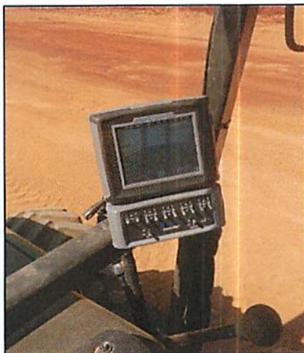
Figura 2 Controlador de vazão
