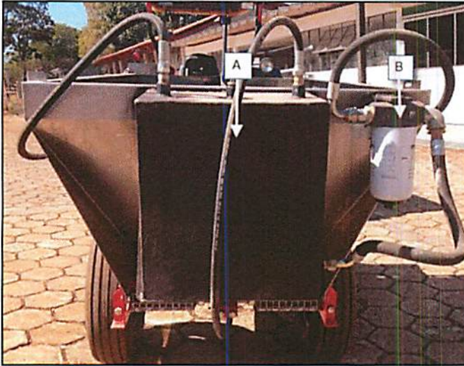
Figura 16 Vista traseira do sistema de distribuição à taxa variável. Sendo (A) reservatório de óleo e (B) filtro de óleo.
