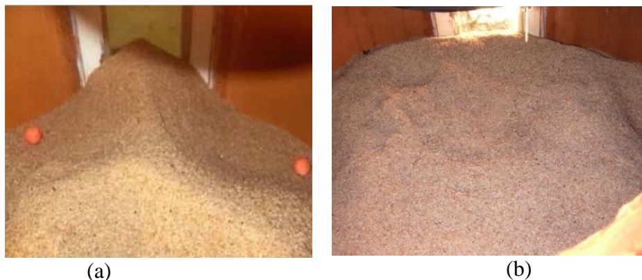
FIGURA 4. Exemplo da condição final da superfície da camada da areia mostrando detalhes da movimentação para a placa difusora original (a), e para a placa difusora avaliada (b). Example of the final condition of the sand layer surface showing details of movement for the original diffuser plate (a) and for the diffusion plate evaluated (b).
