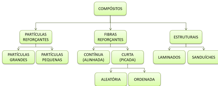
Figura 2.1 – Esquema de uma das formas de classificação dos materiais compósitos.
