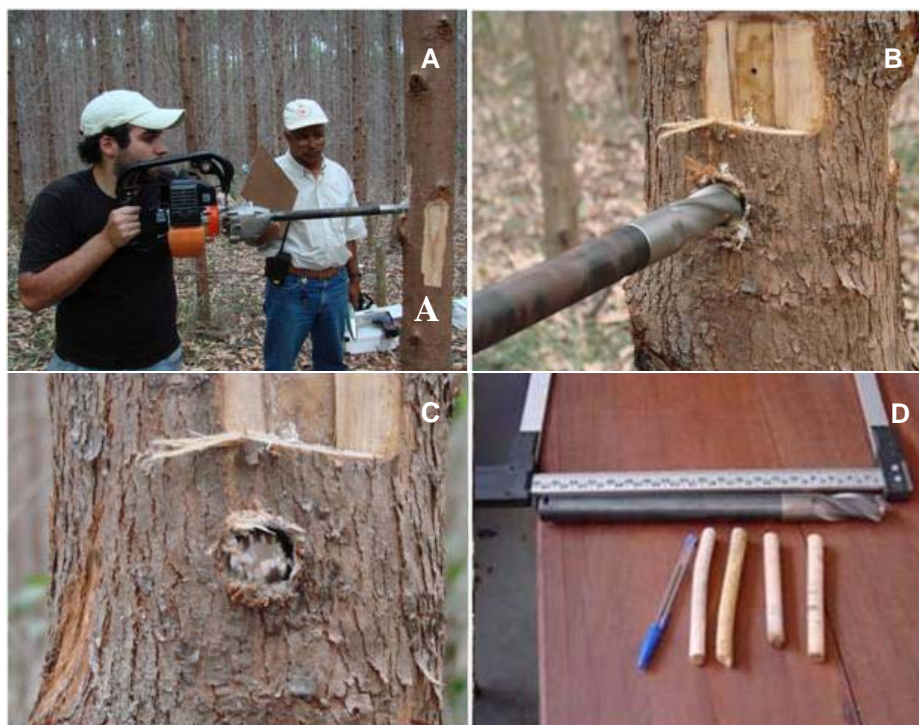
FIGURA 3 Trado motorizado em funcionamento, em que: A: equipamento perfurando o tronco, B: detalhe da perfuração, C: furo deixado pela broca, D: detalhe da broca e baguetas.
