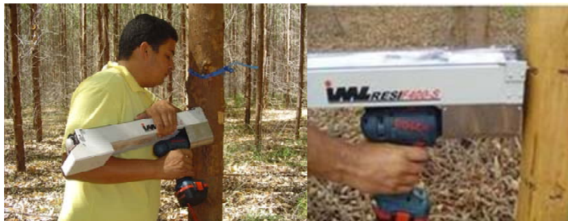
FIGURA 2 Resistógraph® em aplicação na árvore viva para a obtenção de dados de resistência mecânica à penetração de uma haste metálica na madeira.
