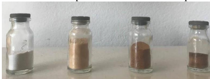
Figura 13- Materiais sulfatados produzidos com diferentes quantidades de ferro.
