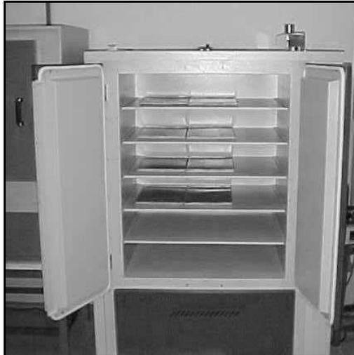
FIGURA 7 Estufa utilizada para desidratação do purê de banana.
