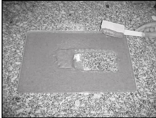
FIGURA 6 Foto de uma bandeja de Plexiglass utilizada na desidratação do purê de banana.
