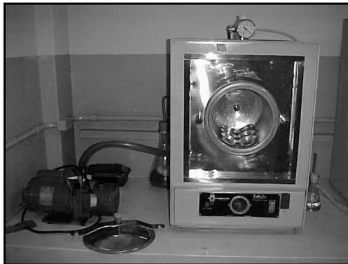
FIGURA 8 Estufa a vácuo para determinação de umidade de purê de banana.
