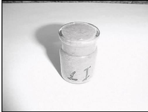
FIGURA 9 Pesa filtro utilizado na determinação da densidade de purê de banana.
