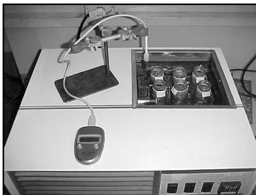
FIGURA 13 Sistema utilizado na medição de condutividade térmica de purê de banana.
