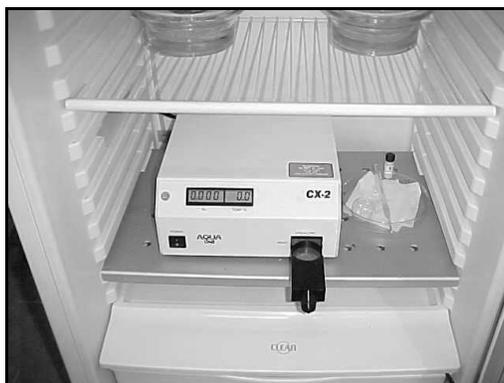
FIGURA 10 Higrômetro de ponto de orvalho eletrônico utilizado para a determinação da atividade de água de purê de banana em higrômetro eletrônico.
