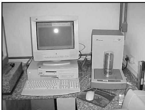
FIGURA 14 Calorímetro Diferencial de Varredura (DSC) utilizado para determinação do calor específico do purê de banana.
