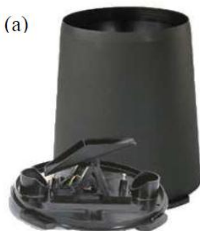
Figura 14 – Pluviômetro automático com detalhamento do sistema de báscula.
