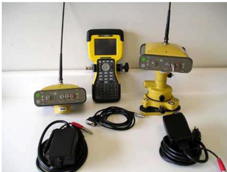
Figura 16 – GPS topográfico de dupla frequência e comunicação RTK, utilizado para levantamentos de alta precisão.
