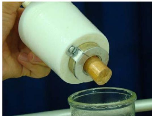
Figura 7 Corpo-de-prova conectado ao conjunto de rolhas.
