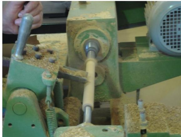
Figura 4 Torneamento dos corpos-de-prova prismáticos.
