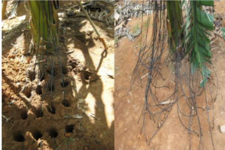
Figura 9 Vista da instalação das sondas de TDR, posicionadas em um plano bidimensional radial à planta, Guanambi - BA. UFLA, 2011
