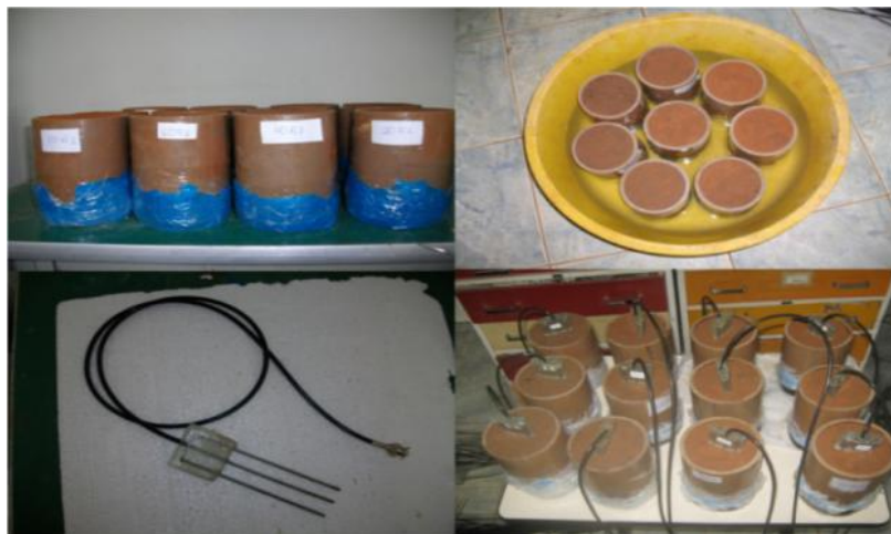
Figura 7 Detalhe da calibração das sondas de TDR com as hastes inseridas completamente no solo após 48 horas de saturação, Cruz das Almas - BA. UFLA, 2011
