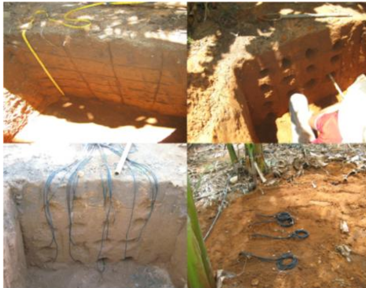
Figura 8 Vista da instalação das sondas de TDR, posicionadas na direção longitudinal à linha de plantio, Guanambi - BA. UFLA, 2011
