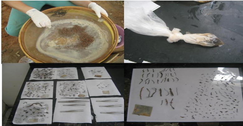
Figura 5 Fotografias ilustrativas dos detalhes da separação das raízes do solo, da individualização e distribuição das raízes em filmes de transparências, Cruz das Almas - BA. UFLA, 2011
