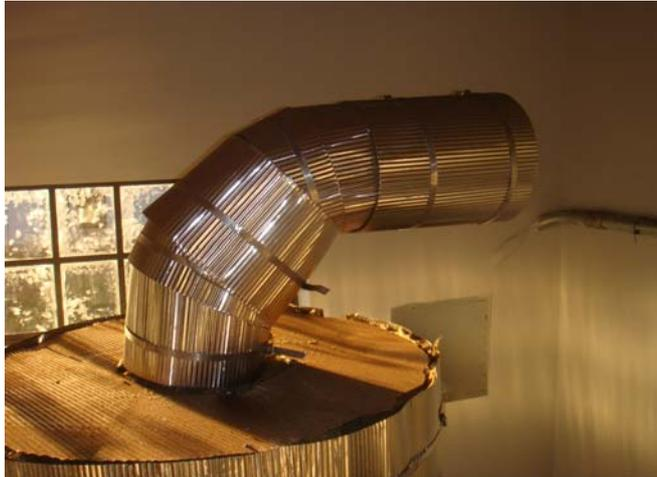
FIGURA 12 Detalhe da parte superior do ciclone
