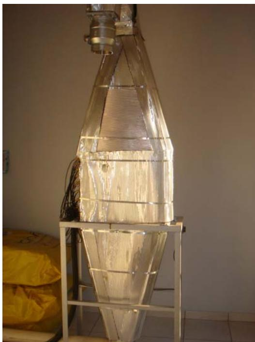
FIGURA 9 Detalhe do aquecedor de ar com conjunto de resistências
