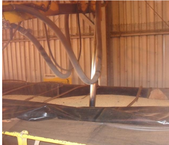
Imagem 9 – Equipamento que recolhe a soja para classificação
